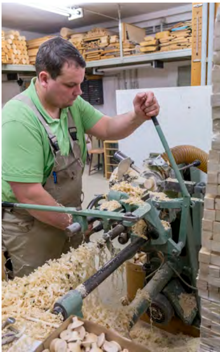
Die Grundformen werden an Drechselmaschinen gedreht.
