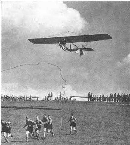
Kurz nach dem Ausklinken des Gummiseils eines SG 38 am Hang des Adelsberger Flugfeldes.
